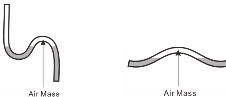
Ошибки в прокладывании шлангов
